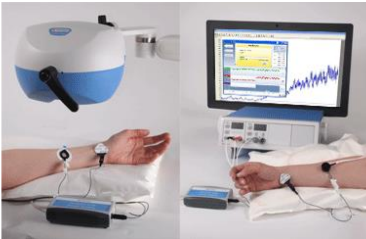
Figura 1: Sistema de fluxometria laser speckle cutâneo acoplado à microiontoforese de substâncias vasoativas. Na técnica de iontoforese, uma corrente elétrica de baixa intensidade carrega íons de substâncias vasodilatadoras através da pele íntegra, resultando em aumento do fluxo sanguíneo microcirculatório e da perfusão tecidual.
