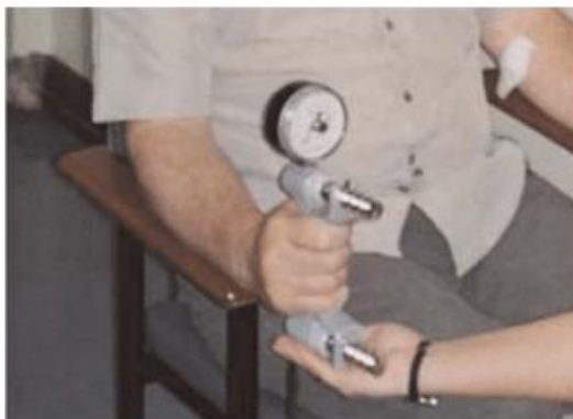
FIGURA 3 – POSIÇÃO DO DINAMÔMETRO NA MÃO PACIENTE PARA AVALIAÇÃO DE FORÇA DE PREENSÃO MANUAL.
